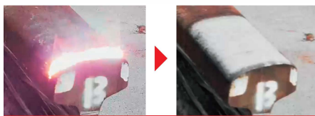
鉄道レール錆取り
