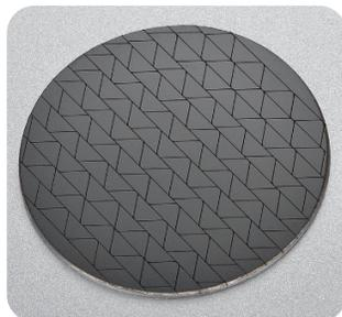
複合チップが材料取りは、切断パターン無制限、高効率、シャンクに溶接前のプロセス;
