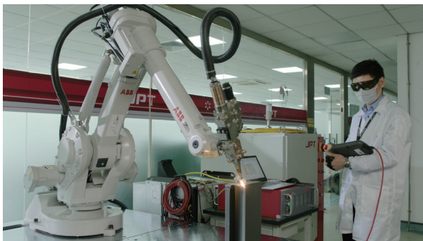
JPT连续光纤激光器配合机械臂焊接应用测试
